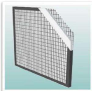
Il filtro sintetico è impiegato per la filtrazione di polveri, costituito da fibre di poliestere termoreticolate, possiede un'elevata capacità di intrattenimento delle polveri con bassa perdita di carico. Non tossici, inattaccabili da microrganismi e prodotti chimici.
