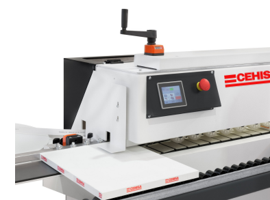
Regolazione semplice dello spessore pannello
