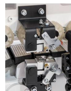
Nuovo T-4X Gruppo Multi-funzione con lame flottanti
