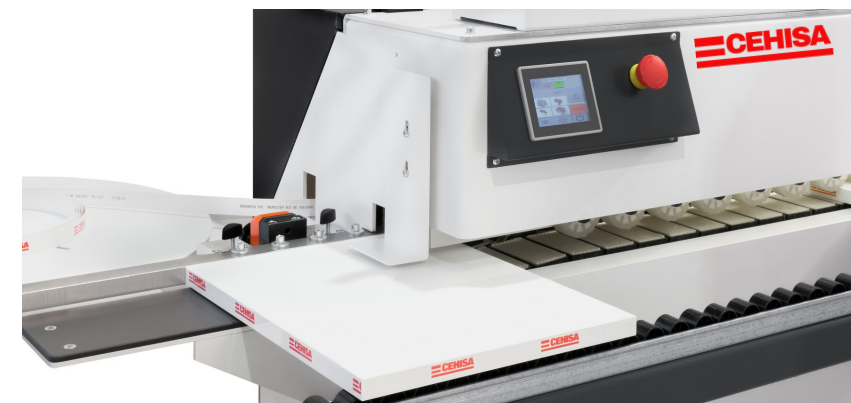
Pannello di controllo Touchscreen 3,5" PLC Industriale
