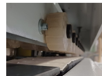
Pressore centrale con doppia fila di ruote
